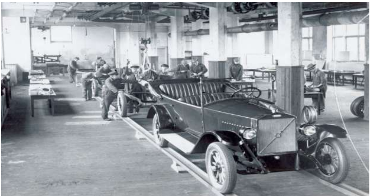
Cadena de montaje de producción en serie de automóviles Ford. Fuente Internet.
